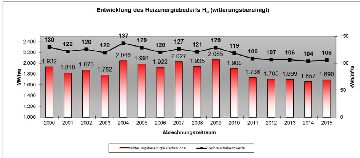
Wie bereits in den vergangenen Energieberichten dargestellt, wurde in der Heizperiode 2009/2010 die Steuerung der Heizungsanlage des Schulgebäudes erneuert und der Betrieb optimiert. Der Heizenergieverbrauch des Gesamtkomplexes hat sich in der Folge sukzessive verringert. Betrachtet man einzelne Gebäudeteile, so ergibt sich allerdings ein differenziertes Bild:
