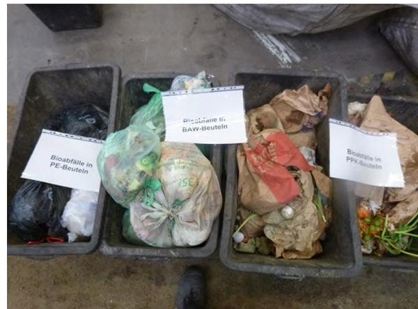
Abb. 18: In Beuteln gesammelte haushaltsstämmige Organik (links: zur Abfuhr bereitstehende Biotonne mit BAW-Beuteln; rechts: aussortierte Beutel – PPK / BAW / PE)
