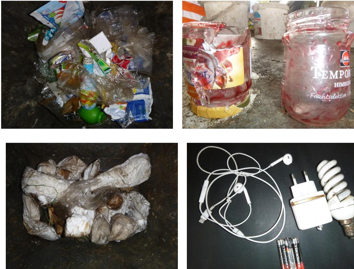
Abb. 6: Fremdstoffe im Bioabfall (oben links: sonstige Kunststoffe; oben rechts: Glas; unten links: Metalle; unten rechts: sonstige Fremdstoffe; unten rechts: schadstoffhaltige Abfälle und Elektroschrott)
