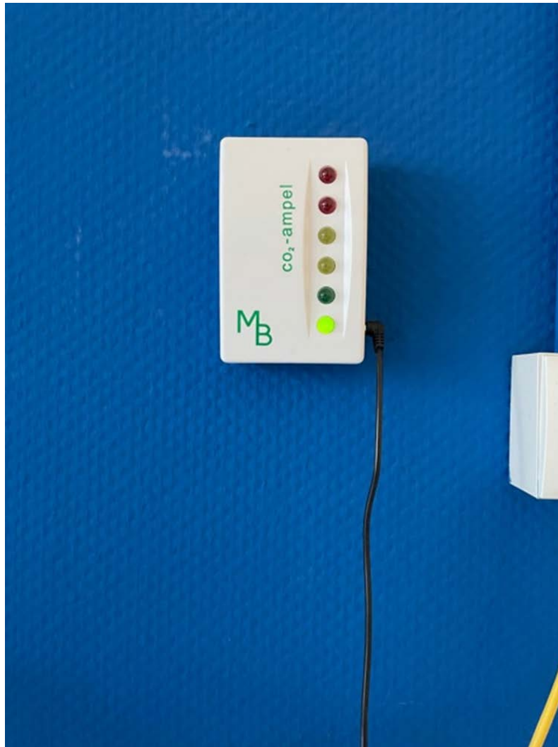
Abb. 10: Fest installierte CO 2 Messgeräte, mit der alle Klassen der Kreis-eigenen Schulen des Kreises Ahrweiler ausgestattet sind.
