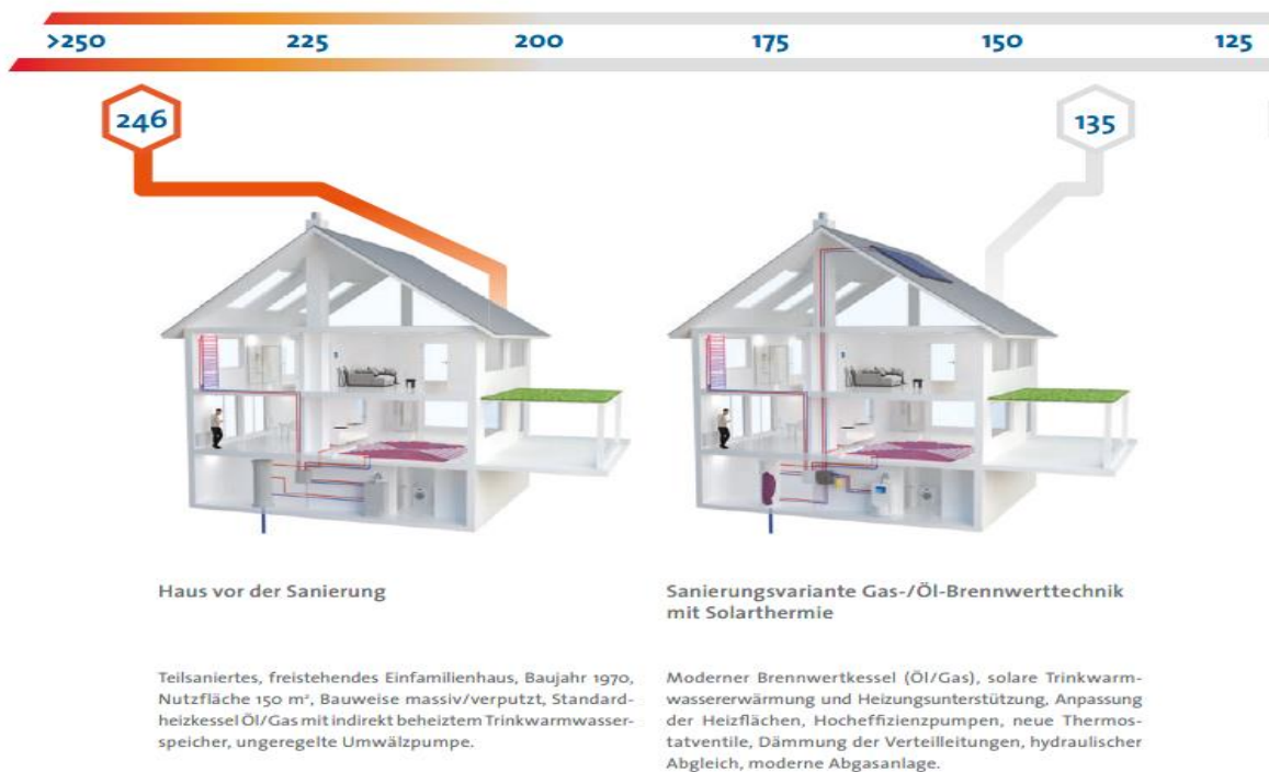
Abbildung 35: Einsparpotenziale durch Nutzung effizienter Heiztechnik (BDH, 2021)
